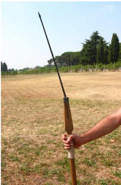
**Fig.4:** piegamento del codolo nel caso in cui non sia ben unito al collare. Questo dimostra dove agisce la forza di impatto.
